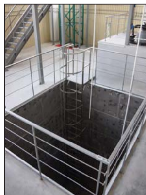
Имитатор семиметрового бассейна выдержки для тренировок специалистов, обслуживающих стенд инспекции ядерного топлива
