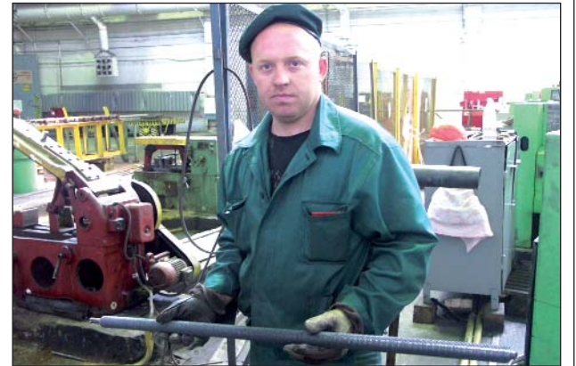
На снимке: токарь Игорь ПОПЫТЬКО демонстрирует усовершенствованную конструкцию и технологами ОП «Атомэнергомах» трубку для теплообмена в воздухоохладителе. Срок службы модернизированного изделия увеличился более чем в 5 раз
